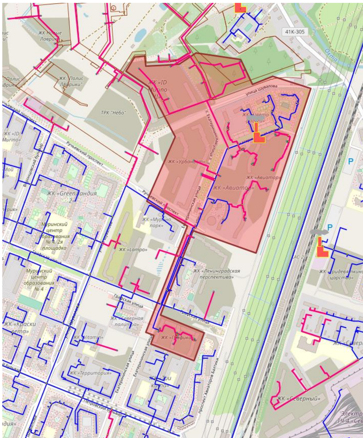
Рисунок 27. Путь для построения пьезометрического графика от котельной ООО «Энергия» до перспективного потребителя
