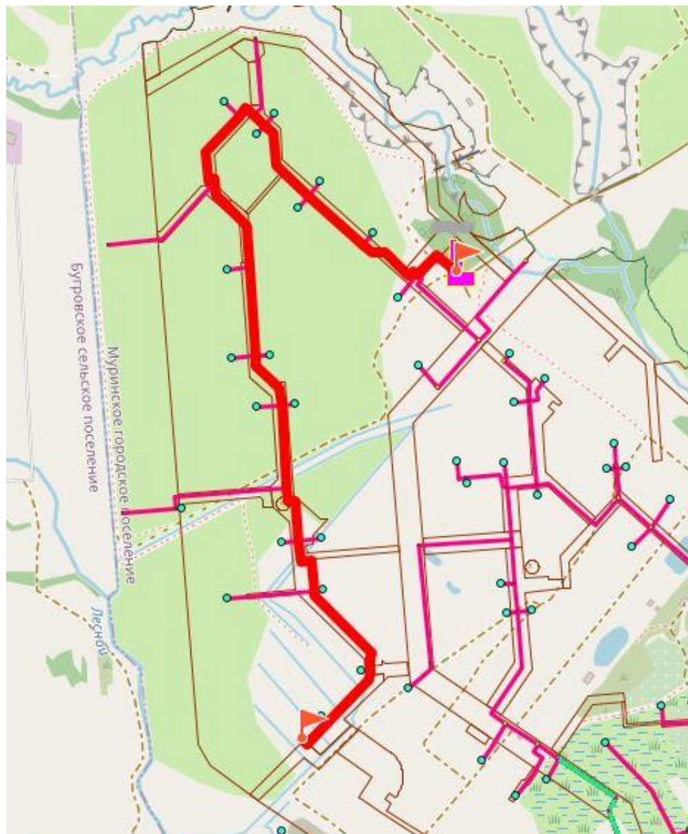
Рисунок 33. Путь для построения пьезометрического графика от котельной №2 (ООО «РТК») до перспективного потребителя
